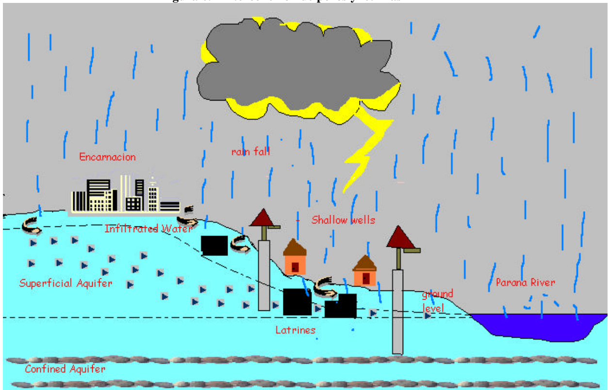
Figura 6.2 Interconexión de pozos y letrinas
